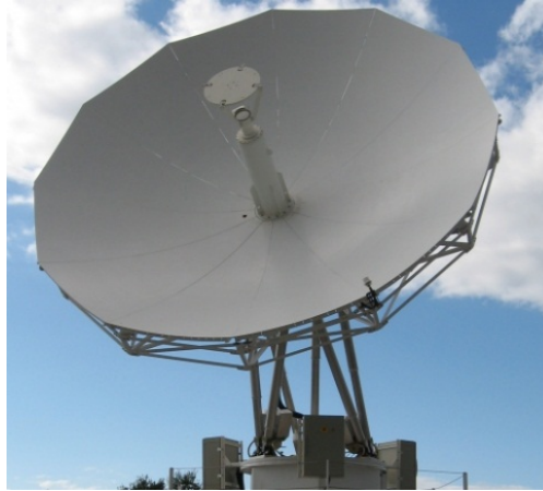
Figura 22 - Antena com posicionador hexapod . Fonte: http://www.zds-fr.com
